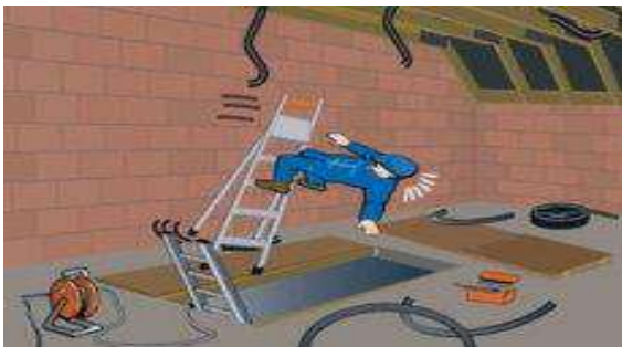
Figure 17 : Illustration des risques de chute de hauteur
